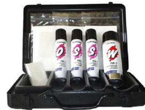
Рис. 1. Аерозольний тестовий комплект «PIR-2».
